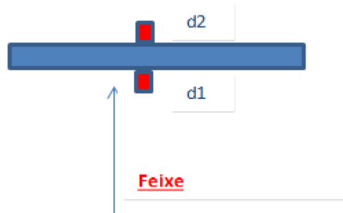
Fig. 14: Esquema representativo do posicionamento dos dosímetros no filé destinado para realização da dosimetria, com a utilização de apenas um irradiador.
