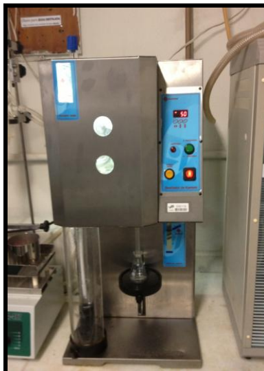
Figura 9: Aparelho da marca Quimis utilizado para realizar a destilação das linguiças toscanas (Controle, F1, F2 e F3).
