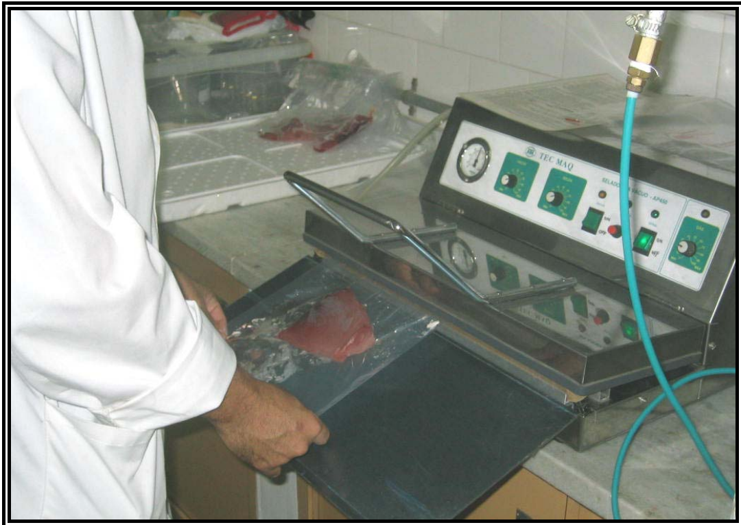
Figura 10. Embalagem das amostras de atum e confecção das atmosferas na seladora a vácuo da marca TECMAQ, modelo AP 450.
