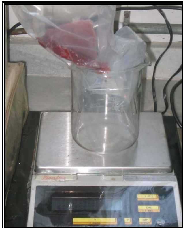
Figura 9. Pesagem das amostras já acondicionadas no interior da embalagem plástica com o auxílio da balança de precisão marca Marte, modelo AM 550 Automarte.
