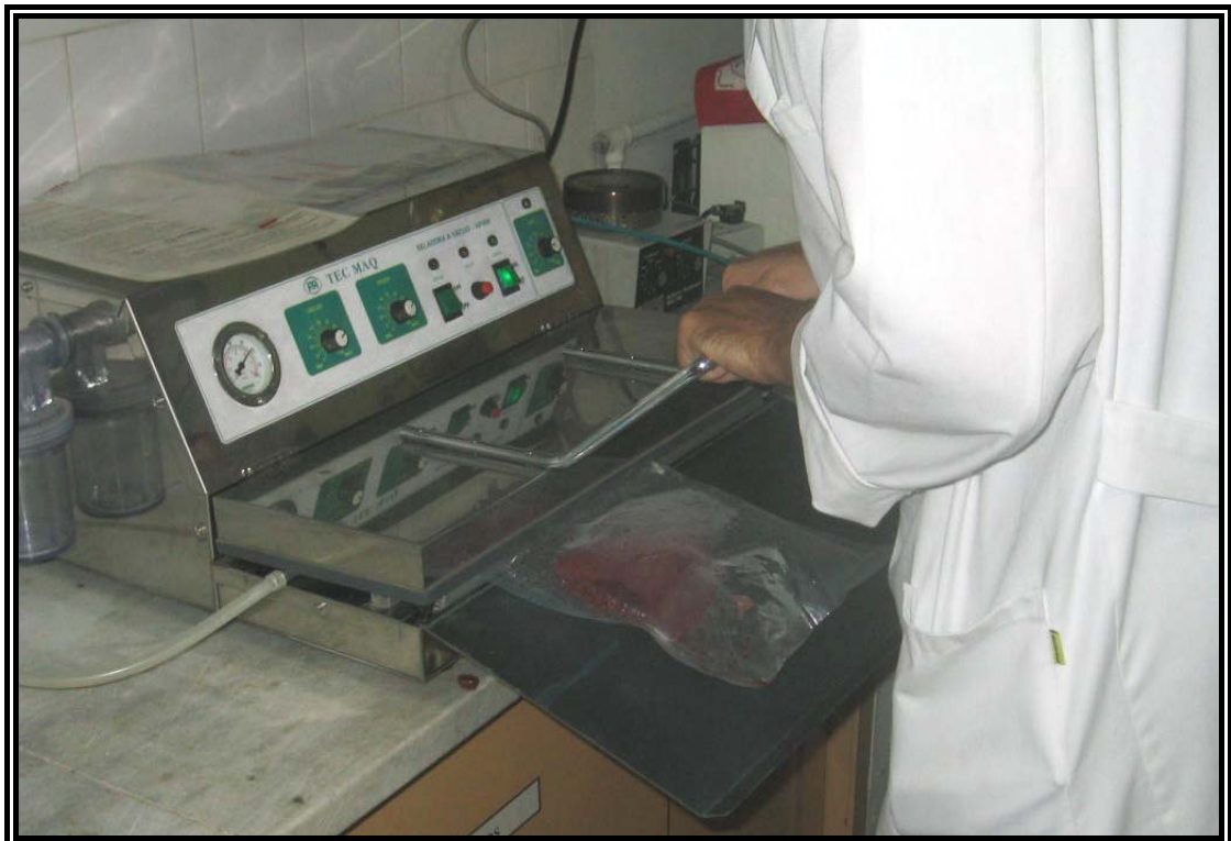
Figura 11. Termo-soldagem da embalagem de atum na seladora a vácuo da marca TECMAQ, modelo AP 450.
