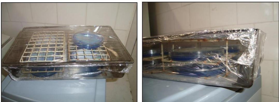
**Figura 11:** Recipiente improvisado, utilizado como câmara úmida nas provas de DNase para classificação das estirpes de *Staphylococcus coagulase* positiva.
