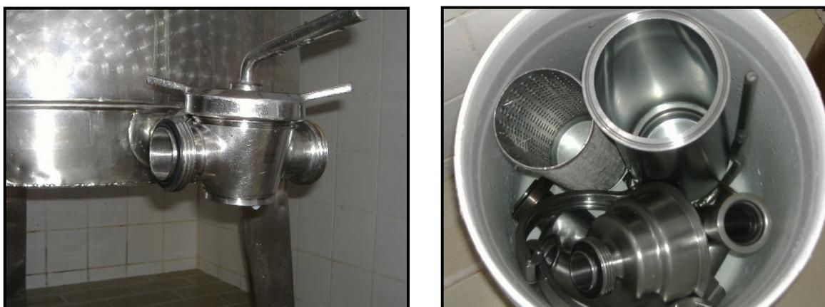
**Figura 8 e 9:** Desarticulação de PCCs realizada durante higienização e imersão das peças em solução com hipoclorito de sódio.
