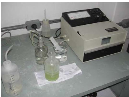
**Figura 7.** Equipamento Bacharach Coleman, modelo MAS-50 B acompanhado do recipiente de vidro contendo uma amostra digerida e becker com solução redutora.
