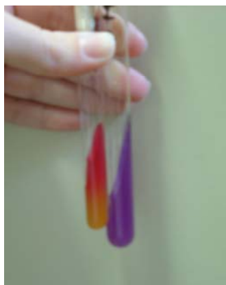
Figura 19 À esquerda meio TSI com fundo amarelo e bisel vermelho; à direita, meio LIA com coloração violeta.
