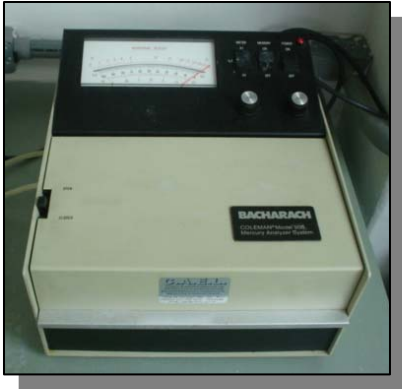
Figura 16. Analisador Bacharach Coleman, modelo MAS-50 B
