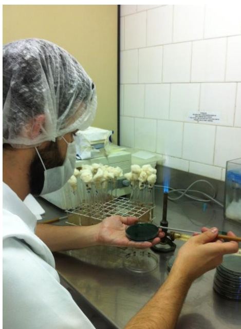
Fig. 14: Realização de estriamento em placa contendo TCBS, no Laboratório de Controle Microbiológico de POA, UFF, 22/08/12.
