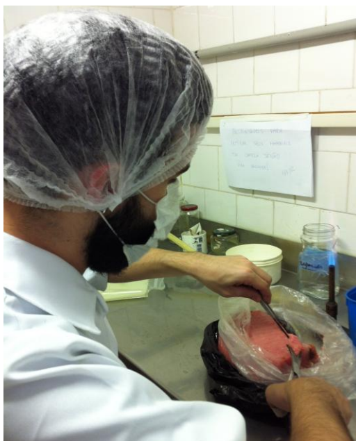
Fig. 5: Retirada asséptica de 75 g de amostra, no Laboratório de Controle Microbiológico de POA, UFF, 07/08/12.
