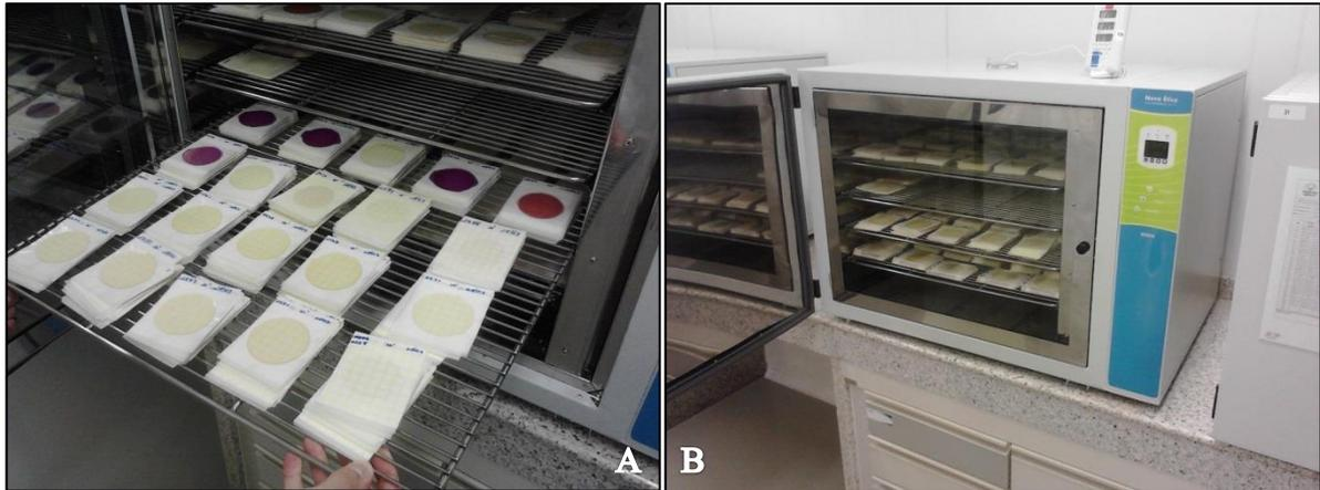
Figura 30 – (A) Pilhas de no máximo 20 placas na estufa. (B) Estufa de incubação.
