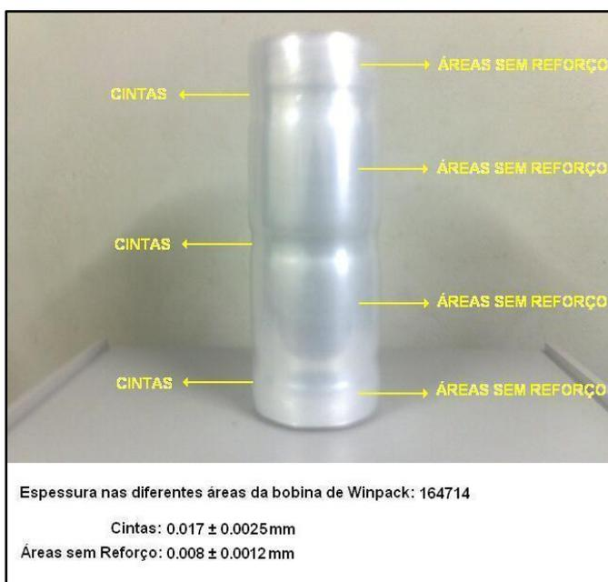
Figura 04 - Rolo de polietileno de baixa densidade usado para revestimento das meias carcaças
