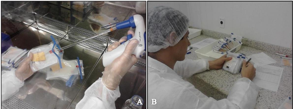
Figura 24 - (A) Umidificação das esponjas com 10 ml de SSPT previamente aos esfregaços. (B) Recebimento de amostras no laboratório para controle interno.
