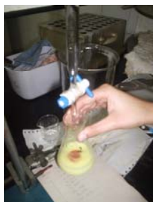
Figura 10. Etapa final da análise de sódio (titulação com solução de \text{AgNO}_3 0,1 N).
