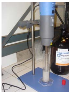
Figura 11. Aparelho onde foi realizada a extração dos lipídeos (IKA ® Ultra Turrax T18 basic ).
