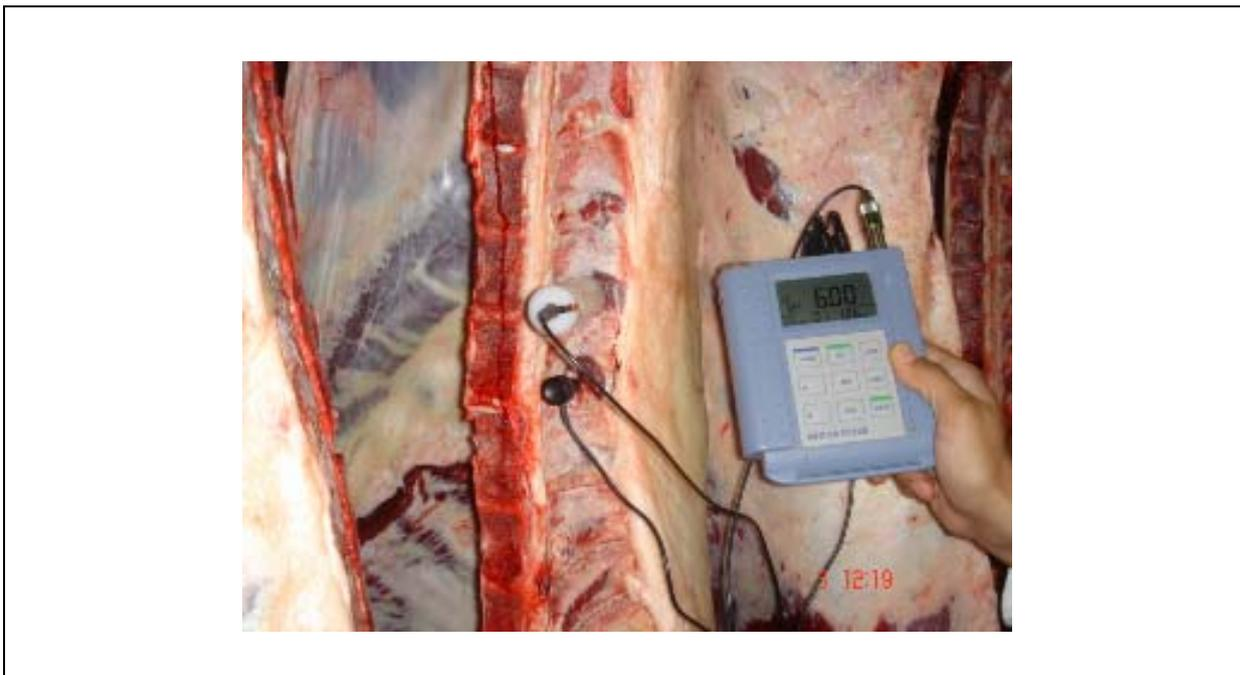
FIGURA 2 – Determinação do pH e da temperatura de uma meia carcaça durante a refrigeração com o potenciômetro de inserção Mettler Toledo 1140.
