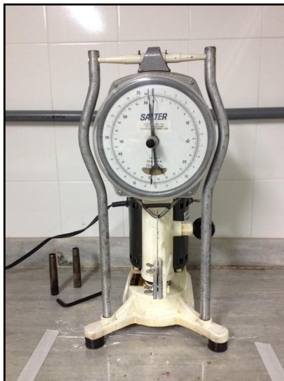
Figura 4: Warner-Bratzler Meat Shear Force – modelo 3000, utilizado para obtenção da força de cisalhamento.
