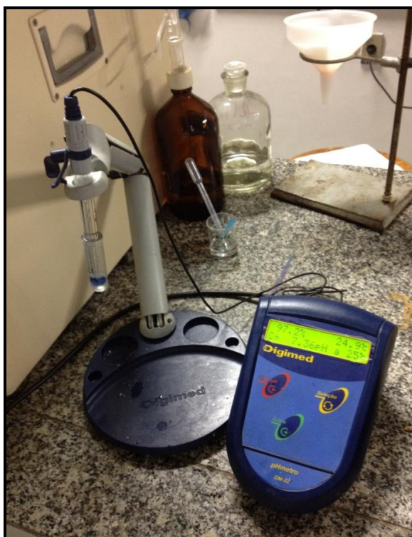
Figura 2: peagômetro marca Digimed modelo DM-22, utilizado na aferição do pH das amostras de picanha bovina resfriada.
