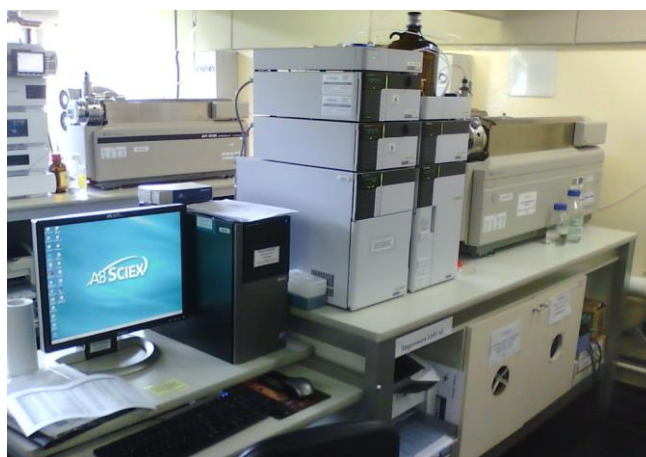
Figura 10. Espectrômetro de massas triplo quadrupolo/ Ion Trap Linear (4000 QTRAP®) da AB Sciex equipado com fonte de ionização electrospray . LANAGRO/MG, Pedro Leopoldo, 2013.
