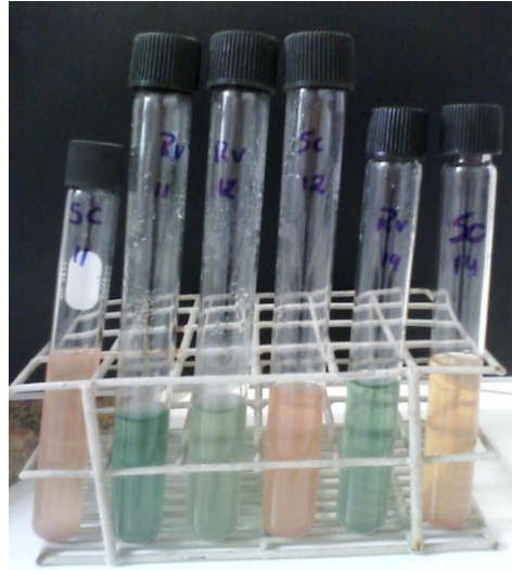
Figura 4. Tubos contendo Selenito - Cistina e Rappaport Vassiliadis inoculados com 1mL e 0,1mL de amostras pré- enriquecidas, respectivamente. Laboratório de Sanidade Avícola da Universidade Federal Fluminense, Niterói, 2013.
