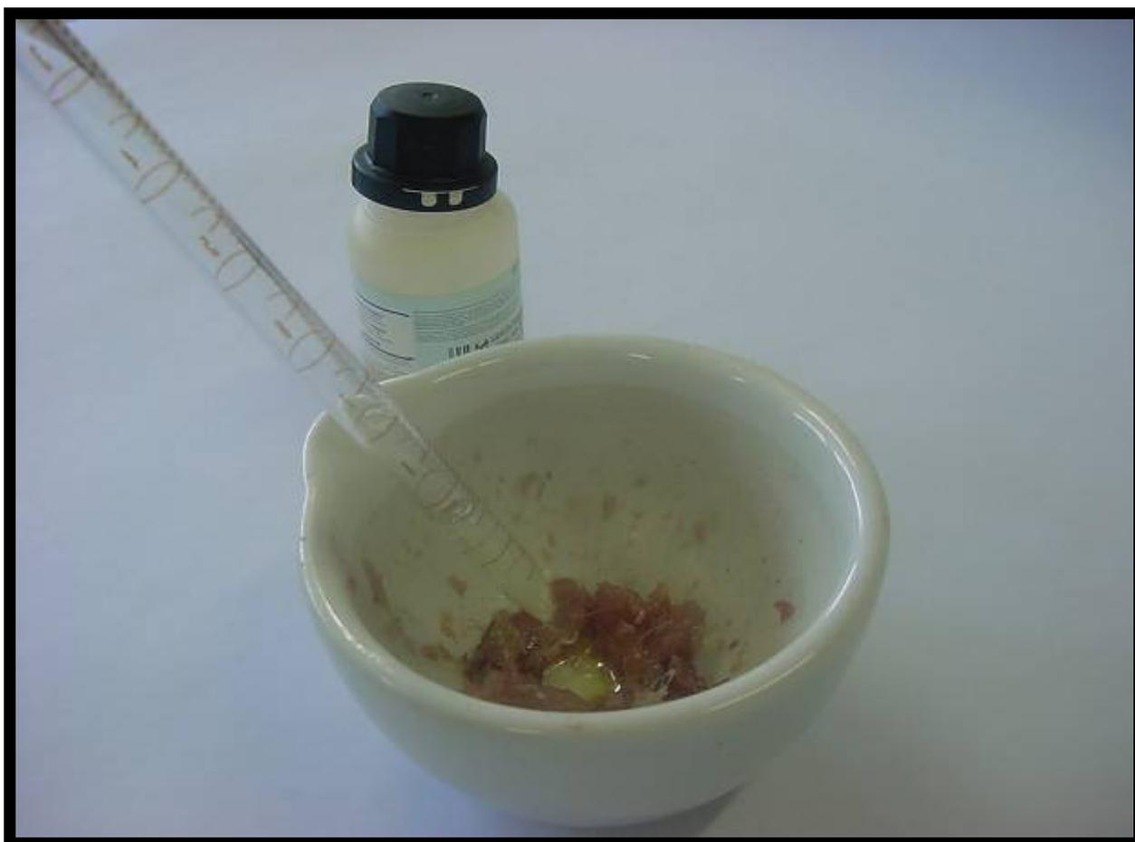
Figura 8 - Reação calorimétrica da prova de Nessler para amônia
