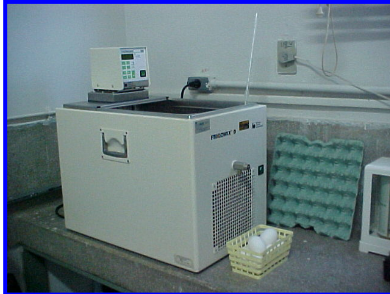
Figura 3. Banho-maria Thermomix ® BM modelo Frigomix ® B
