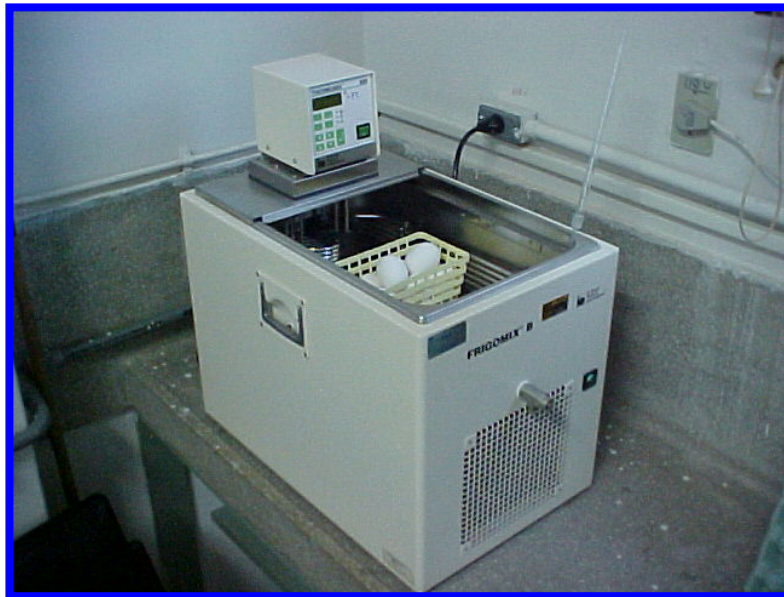
Figura 4. Amostra de ovos no interior do banho-maria Thermomix® BM modelo Frigomix® B
