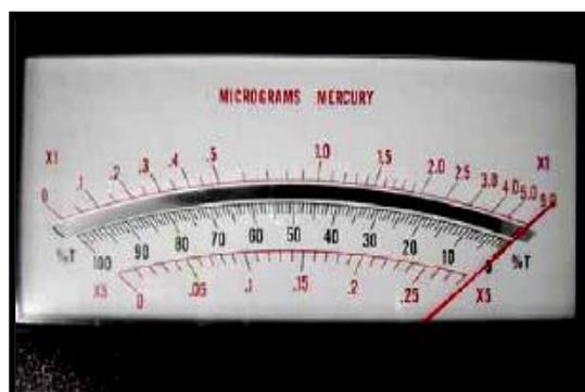
**Figura 5.** Detalhe da escala do aparelho, onde é realizada a leitura do teor de Hg total em  $\mu\text{g}\cdot\text{g}^{-1}$ .
