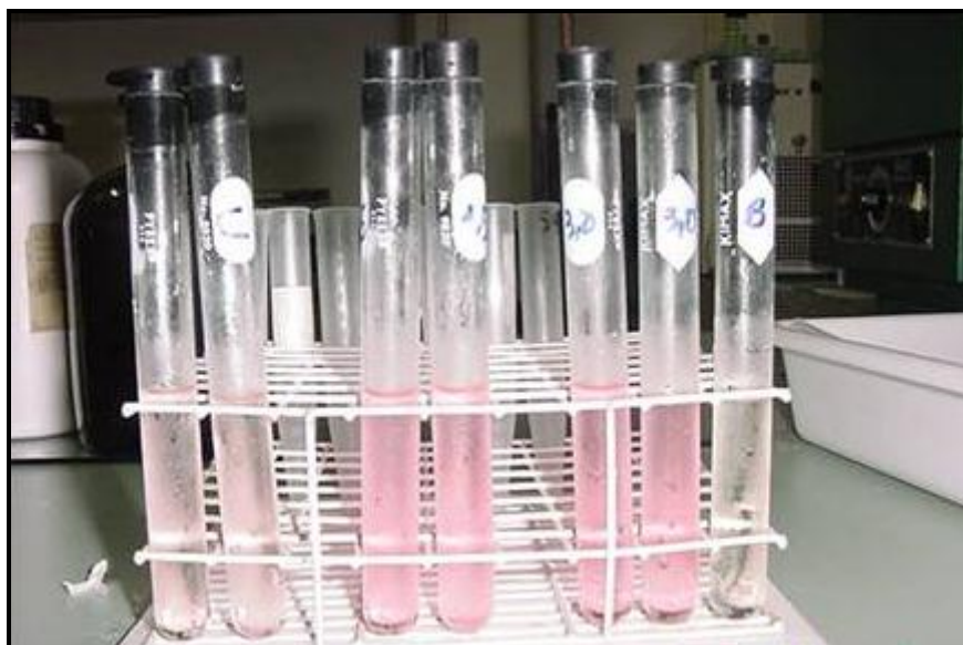
Figura 12: Reação do ácido 2-tiobarbitúrico com 1 mol de aldeído malônico ou de seus tautômeros originados na oxidação dos lipídeos, resultando em composto de coloração vermelha.
