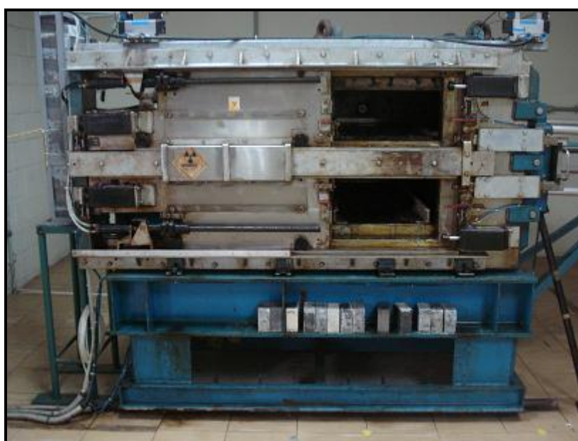
Figura 8: Irradiador do Centro Tecnológico do Exército com fonte de céσιο-137, localizado em Guaratiba, Rio de Janeiro.
