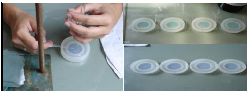
Figura 9: Etapa de titulação da análise de Bases Voláteis Totais (BVT) (lado esquerdo) e ponto de viragem do indicador de Tashiro (lado direito).
