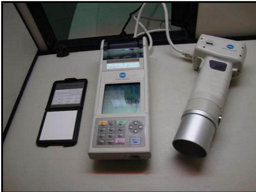
Figura 2: Colorímetro portátil *Konica Minolta* modelo CR 400 calibrado com uma placa branca padrão ( $Y = 94,2$ ;  $x = 0,3160$  ;  $y = 0,3326$  ).
