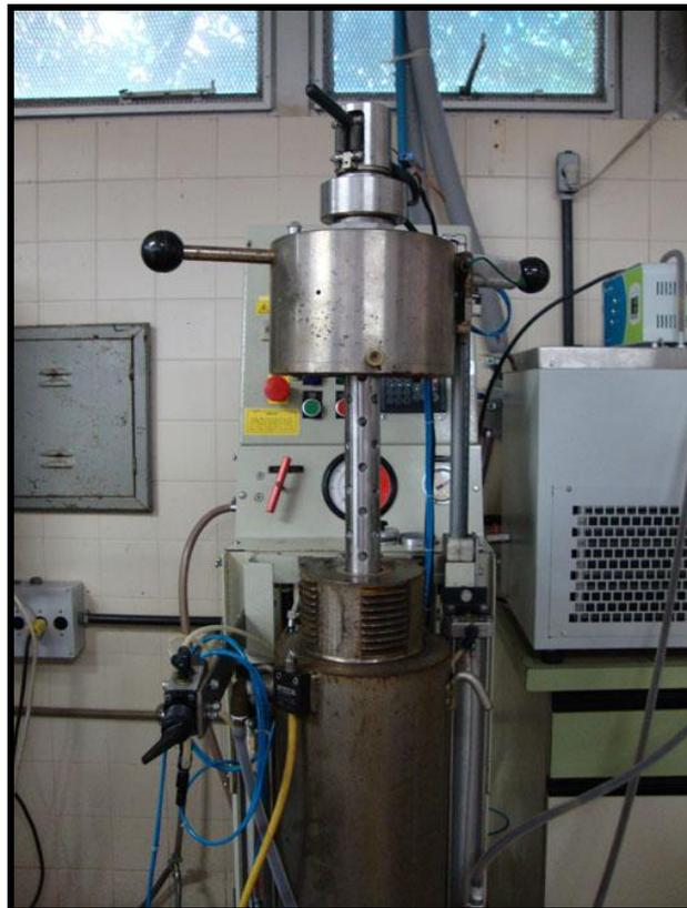
Figura 1: Equipamento piloto de alta pressão hidrostática (*Stansted Fluid Power* - modelo S-FL-850-9-W).
