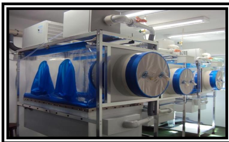
FIGURA 1 Unidades isoladoras localizadas no Biotério Experimental do Laboratório de Sanidade Avícola da Faculdade de Veterinária da Universidade Federal Fluminense (UFF)
