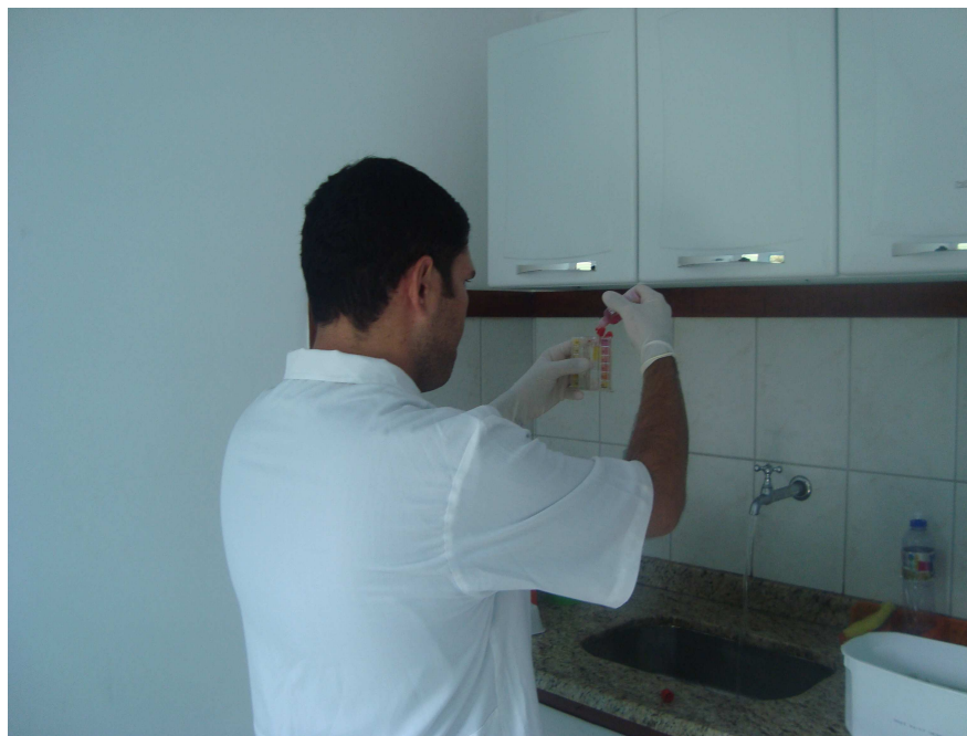
Figura 5 Mensuração de CRL e pH durante a coleta de amostra na torneira da cozinha de estabelecimento de manipulação de alimento. Areal, RJ. 14 de dezembro de 2010.
