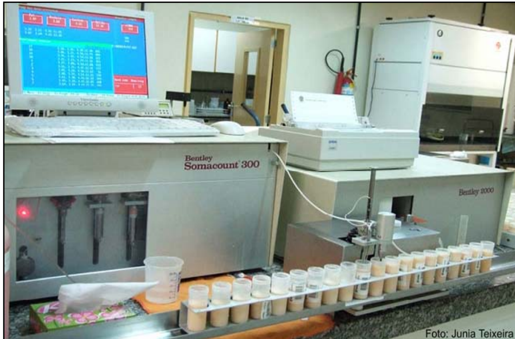
Figura 9 Equipamentos eletrônicos “Somacount 300” e “Bentley 2000” da Bentley Instruments Incorporated®, Minnesota, EUA, utilizados para a CCS e determinação de componentes físico-químicos em amostras de leite.
