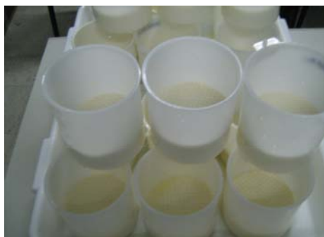
Figura 3- Enformagem do queijo Minas Frescal, realizada no Laboratório de Tecnologia e Inspeção de Leite e Derivados da Faculdade de Veterinária da UFF, em 2009.
