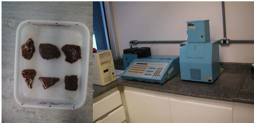
FIGURA 10 - Amostras de carne analisadas no S & M Colour Computer modelo SM - 4 - CH da Suga, no sistema Hunter com abertura de 30mm de diâmetro.
