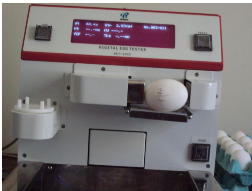
Figura 3 - Teste de resistência da casca à quebra
