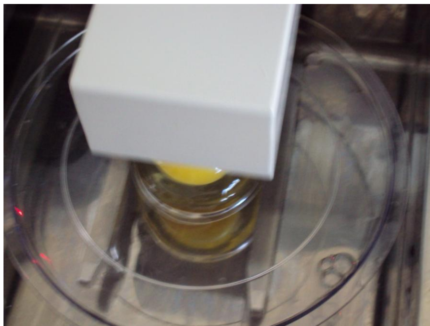
Figura 4 – Leitura à “Laser” para determinar a cor da gema e a altura do albúmen.
