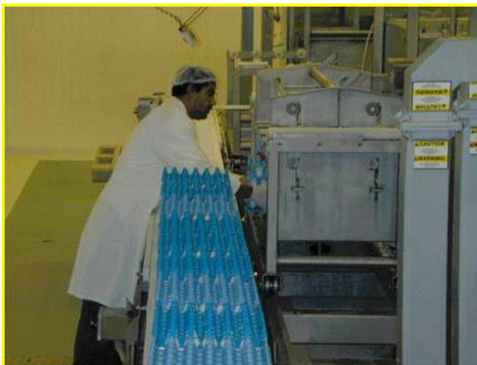
Anexo 4. Processo de pasteurização em casca - Depois de um computador cuidadosamente pesar cada ovo uma esteira transportadora encaminha os ovos para uma série de tanques ultra-limpos com água aquecida. FONTE: NATIONAL PASTEURIZED EGGS (2005)
