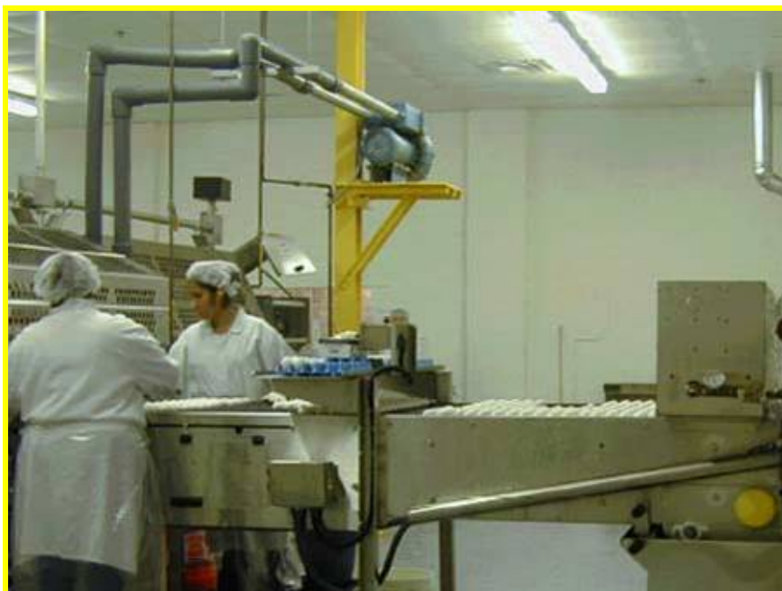
Anexo 7. Processo de pasteurização em casca - Após o período de resfriamento os ovos são embalados com uma cera natural aprovada pelo FDA para se prevenir contaminação de fontes externas e preservar o frescor. FONTE: NATIONAL PASTEURIZED EGGS 2005)
