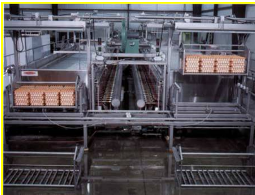
Anexo 5. Processo de pasteurização em casca - Computadores automaticamente ajustam o tempo do processo de pasteurização e fixam a temperatura de acordo com o tamanho do ovos sendo processados. FONTE: NATIONAL PASTEURIZED EGGS (2005)
