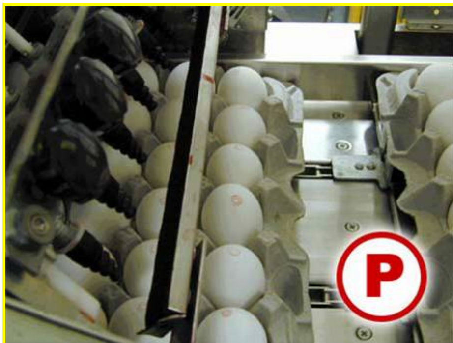
Anexo 9. Processo de pasteurização em casca - Todos os ovos são carimbados com a letra P dentro de um círculo para indicar que eles foram pasteurizados de acordo com as especificações do FDA.
