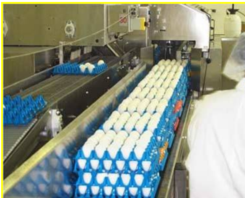
Anexo 8. Processo de pasteurização em casca - Após a pasteurização, os ovos são transportados através de um “candler” (uma máquina que identifica e remove ovos danificados). FONTE: NATIONAL PASTEURIZED EGGS (2005)
