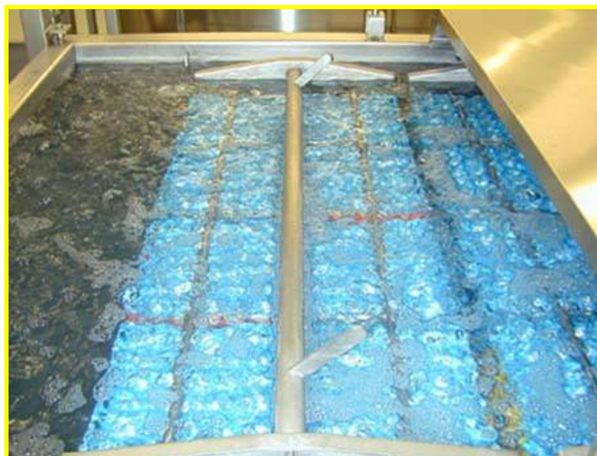
Anexo 6. Processo de pasteurização em casca - A combinação do tempo e temperatura de água aquece o ovo até a temperatura exata necessária para destruir todas as bactérias (redução de 5 log) sem cozinhar o ovo. FONTE: NATIONAL PASTEURIZED EGGS (2005)
