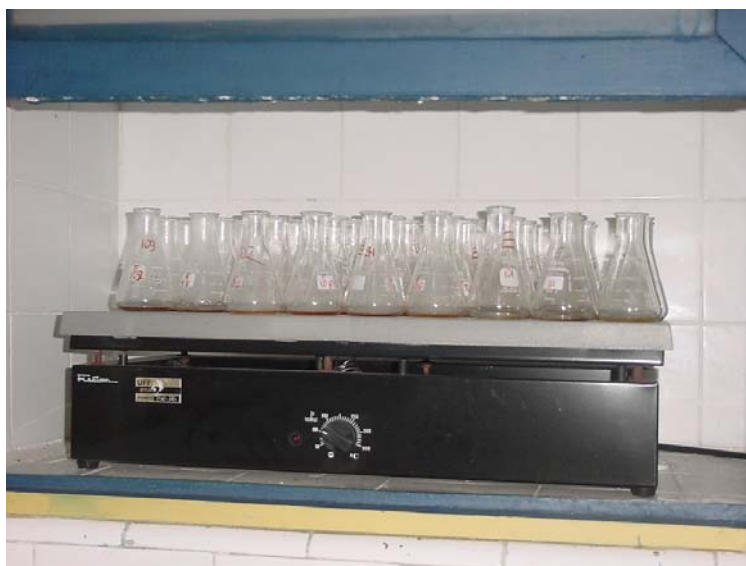
Figura 8: Processo de mineralização das amostras estudadas em uma mistura de \text{HNO}_3 e \text{HClO}_4 em capela de exaustão de gases sob temperatura de 120^\circ\text{C} .
