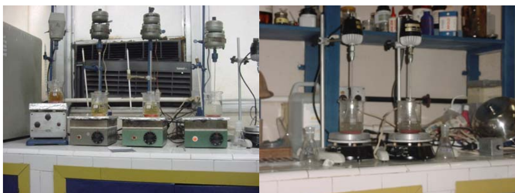
Figuras 10 e 11: Dissolução das amostras mineralizadas em HCl 0,5 N para fornecimento de uma solução clorídrica em vista a eletrodeposição.
