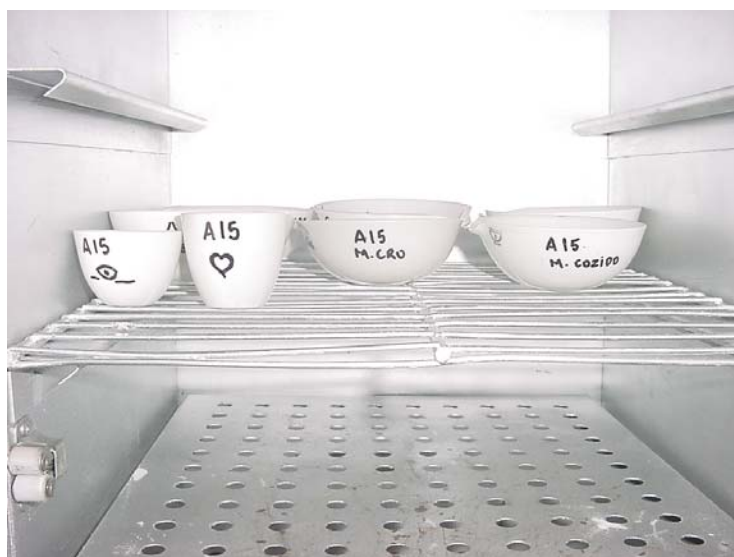
Figura 7: Preparo da base seca das porções estudadas em estufa com temperatura controlada em 80°C.
