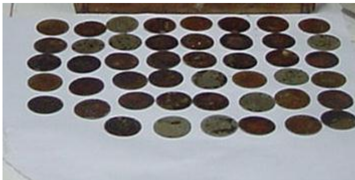
Figura 9: Discos de aço inoxidável para eletrodeposição do ^{210}\text{Po} (lado revestido de resina)
