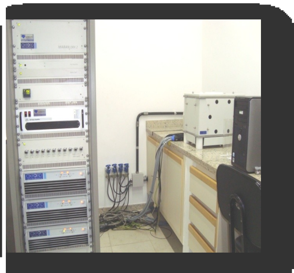
Figura 6. Equipamento de RMN, MARAN DXR 2® (Oxford Instruments).
