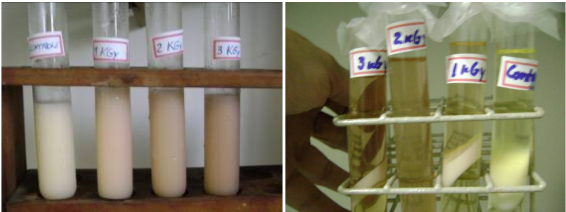
Figuras 17 e 18 – Amostras de leite cru integral irradiadas nas doses de 1, 2 e 3 kGy e amostra controle após reação com o ácido 2TBA antes (A) e após a centrifugação (B) demonstrando maior intensidade de cor conforme aumento da dose de radiação gama.
