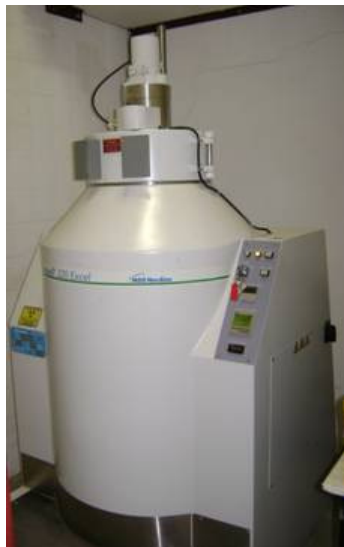
Figura 4 – Irradiador Gama pertencente ao Laboratório de Instrumentação da COPPE/UFRJ, (Co 60 modelo Gammacell Nordion – Canadá).
